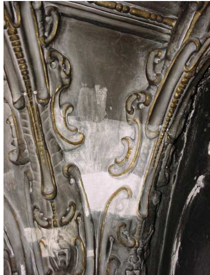
Abb. 10: Korpusspitze. verschiedene Reinigungsmethoden. Von oben nach unten: Absaugen, Tampoon-, Laserverfahren (Foto: G. Mavridis)
